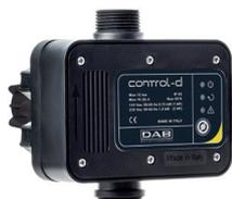
Le CONTROL D est une unité de commande et de protection pour les pompes domestiques sans réservoir à membrane. Grâce à la mesure de débit et de pression intégrée, le CONTROL D peut commander le démarrage et l'arrêt de la pompe ainsi que sa mise en sécurité lors de manque d'eau. L'installation sur la pompe est très aisée.
